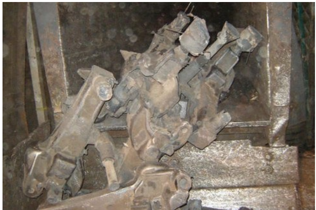
新Delta Phase落砂机（上图）现已在宾夕法尼亚钢铁铸造厂投入使用；一个重型钢铸件搁置在旧落砂系统上（下图）。
