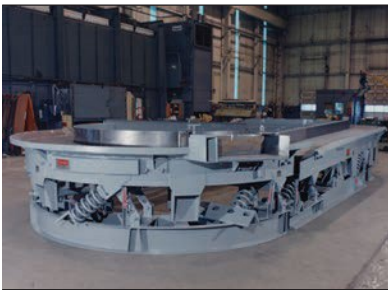
用于清理、分类和研磨的接收输送机 (椭圆形输送机)
